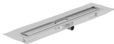
ACO ShowerDrain C Abflusswert 0,91 l/s (gemäß EN 1253-1)
